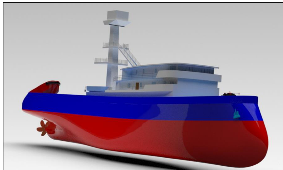
Figura 1.9: Maqueta 3D Buque Atunero con proa invertida
