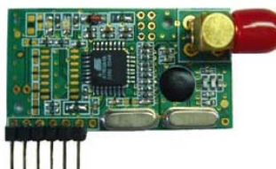
Figura 3.15 – Módulo RF HM-TR/TTL [13]
