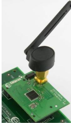
**Figura 3. 9 Módulo CC2431 de Texas Instruments**
