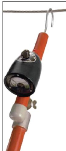
*Figura # 3.5 Detector de ausencia de tensión*
