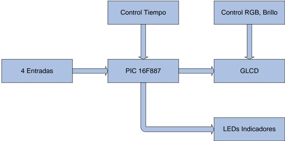
FIGURA 3.1 : Diagrama de bloques del Proyecto
