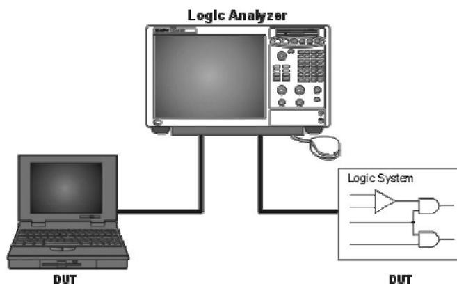
**FIGURA1.2 : Analizador Lógico conectado a PC y Sistema Digital**
