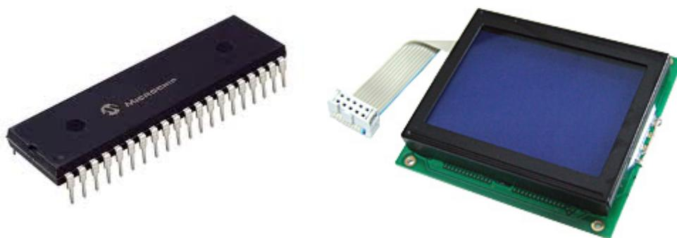
FIGURA 1.1: PIC 16F887 y la Pantalla GLCD
