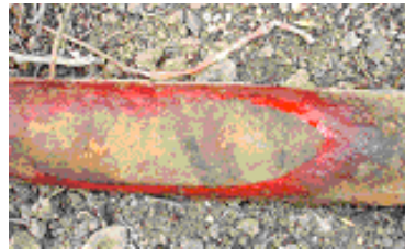
Figura 26 Pozo Tig. 44S tramo 38 TIPO: Corrosión externa SECCION: D Tmm: 0.154" PROFUNDIDAD: 0.021"
