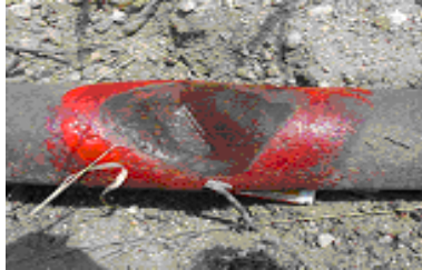
Figura 22 Pozo Tig. 28 tramo 74 TIPO: Sumidura SECCION: A Tmm: 0.158" PROFUNDIDAD: 1.06"
