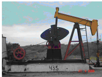
Figura 1.- Levantamiento Artificial por bombeo mecánico.
