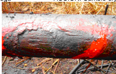
Figura 24 Pozo Tig. 55S tramo 138 TIPO: Fuga ACCION: Cambio urgente
