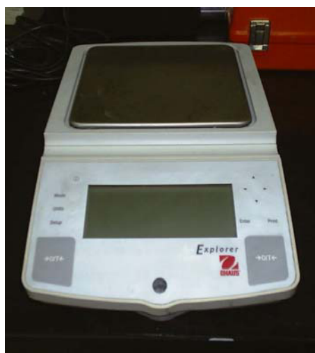
FIGURA 2.7 Balanza para determinar los pesos retenidos
