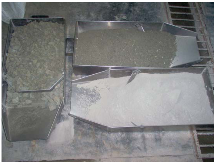
FIGURA 2.14 Cemento y Agregados para mezcla de la BAEC
