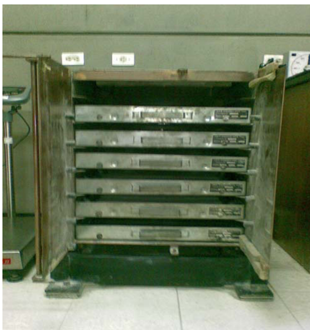
(b) Tamizadora para Agregados Gruesos
