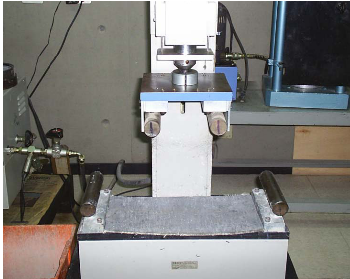
FIGURA 3.34 Equipo utilizado con prensa “ELE” 3000 KN.
