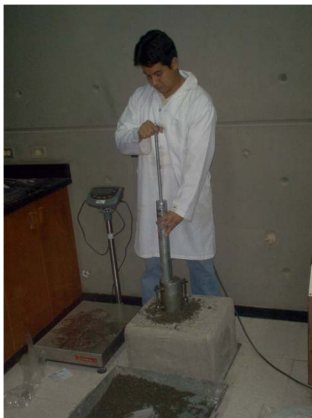
FIGURA 2.13 Procedimiento de Compactación ASTM D558
