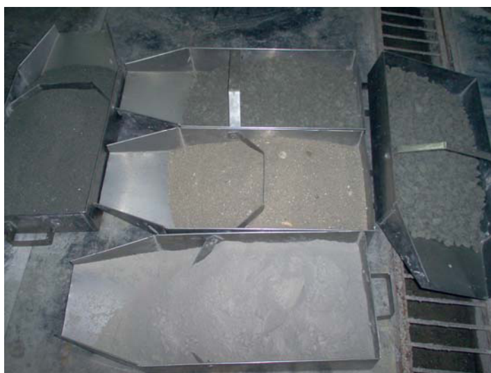
FIGURA 3.19 Cemento y Agregados para mezcla del HCR
