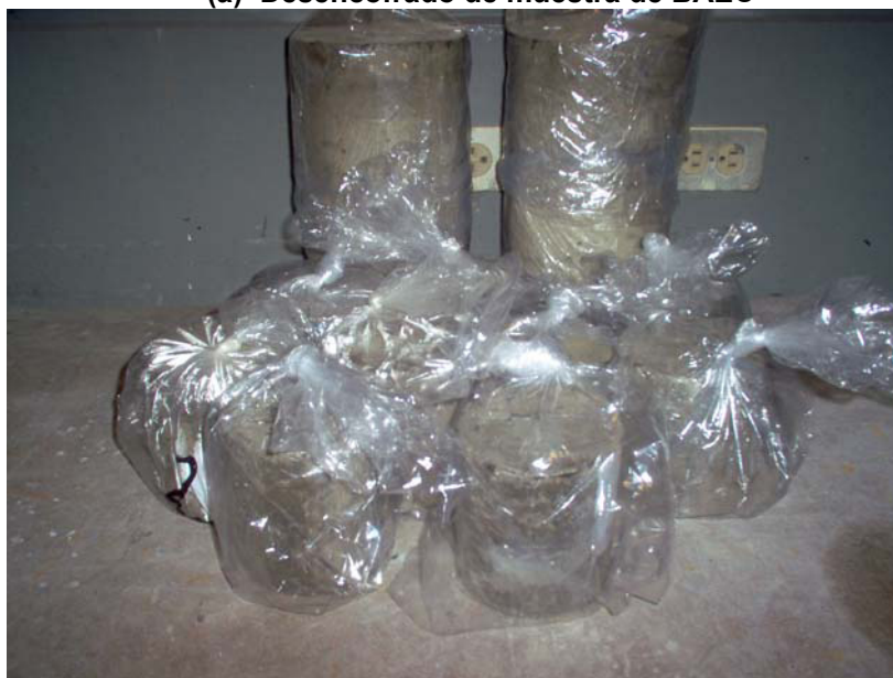
(b) Curado de muestra de BAEC
