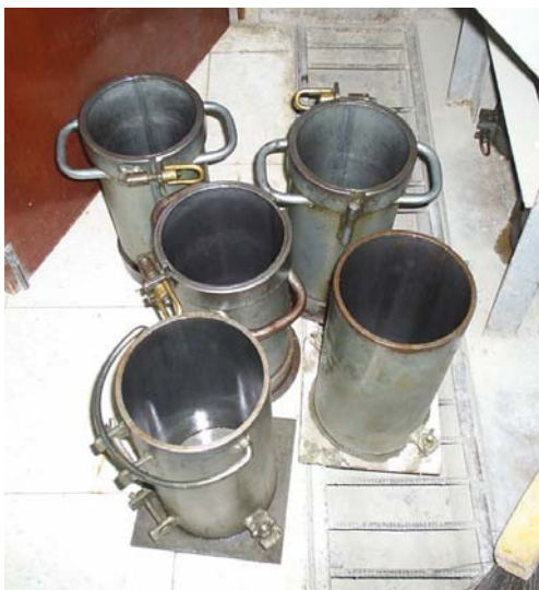
FIGURA 2.18 cilindros metálicos de 150 x 300 mm.
