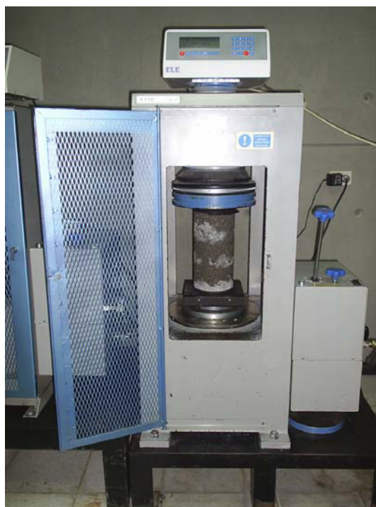
FIGURA 3.31 Procedimiento de rotura (ASTM C39) de muestras de HCR
