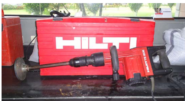
FIGURA 3.26 Martillo eléctrico de compactación
