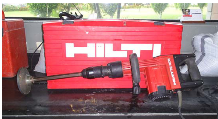
FIGURA 2.19 Martillo eléctrico de compactación
