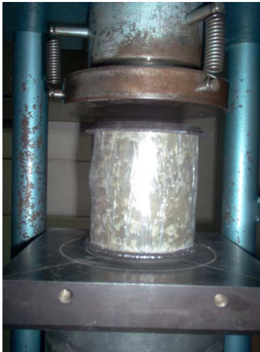
FIGURA 2.23 Procedimiento de rotura (ASTM D1633) de muestras de BAEC
