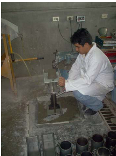
(a) Desencofrado de muestra de BAEC
