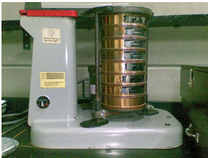
(a) Tamizadora para Agregados Finos
