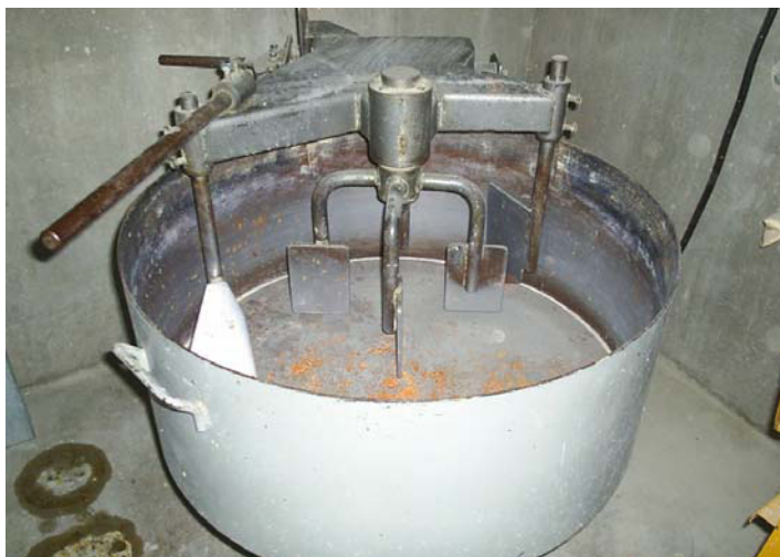
FIGURA 2.16 Mezcladora de artesa
