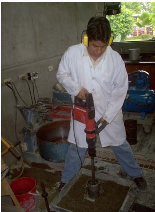
FIGURA 2.20 Procedimiento ASTM C1435 de Compactación de cilindros
