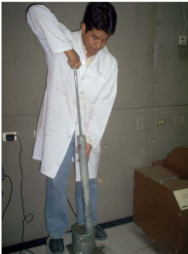
FIGURA 3.18 Procedimiento de Compactación ASTM D1557
