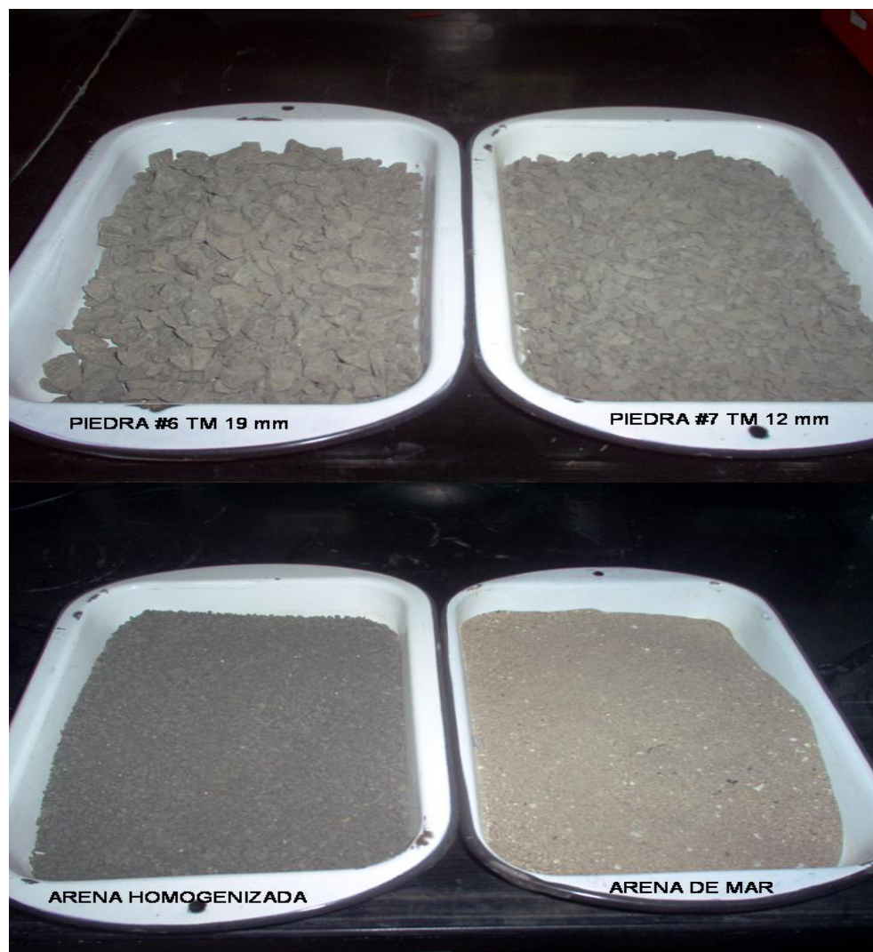
FIGURA 3.9 Muestra de los agregados Finos y Gruesos
