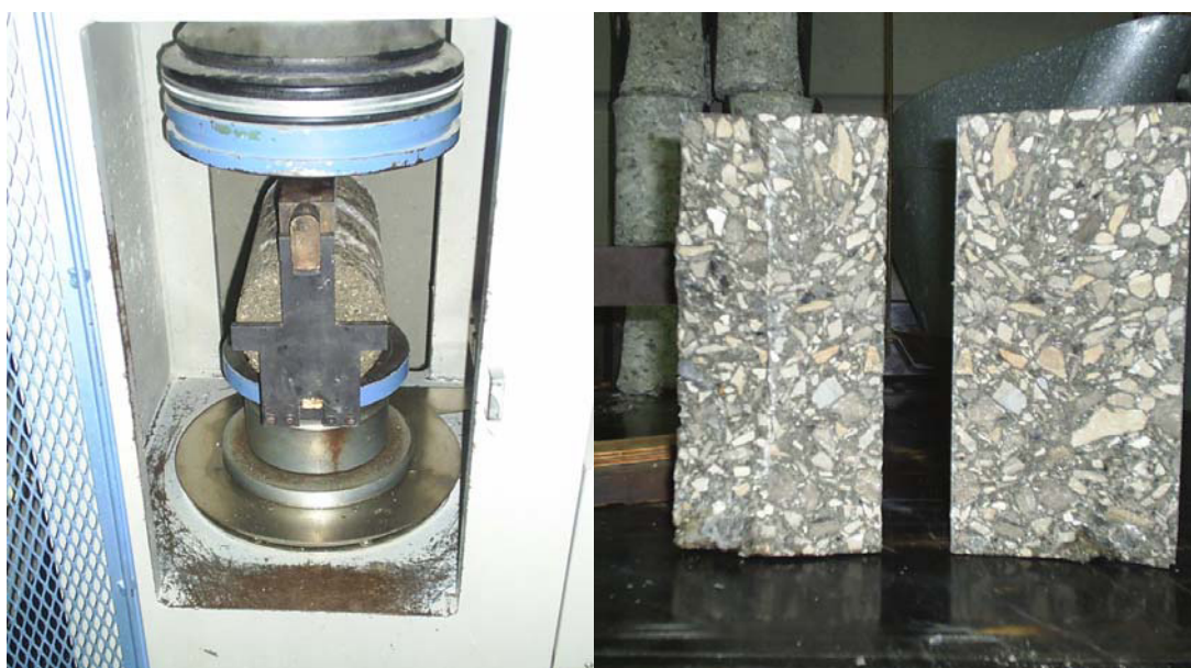
FIGURA 3.33 Procedimiento de rotura (ASTM C496) de muestras de HCR
