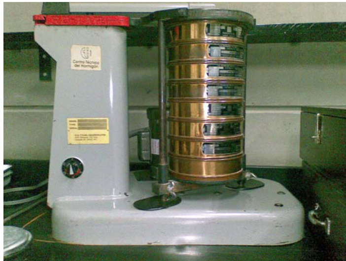
(a) Tamizadora para Agregados Finos
