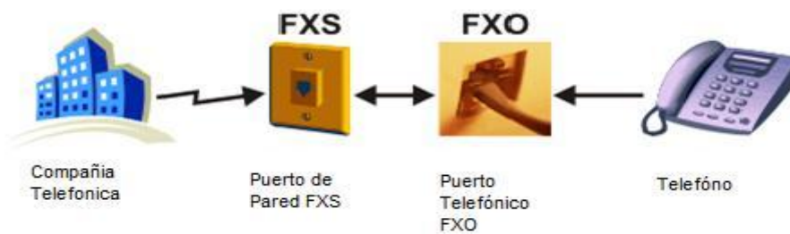
FIGURA 2.3 Esquema de conexión FXS/FXO sin PBX.
