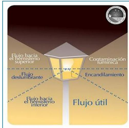
**Figura 3.3** Contaminación debido al tipo de luminaria.
