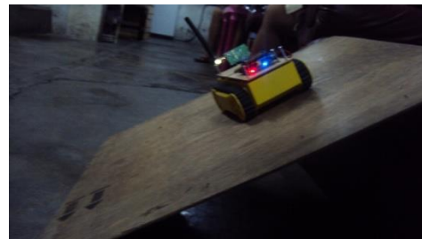
Fig. 4.5.4: Robot oruga girando en superficie inclinada
