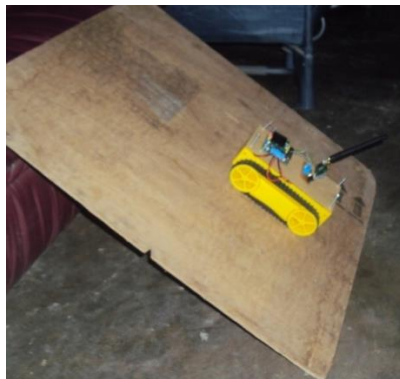
Fig. 4.5.3: Robot oruga subiendo un obstáculo
