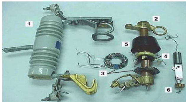
Figura 60: Seccionalizador electrónico con sus partes constitutiva tomado de catálogo CELSA.
