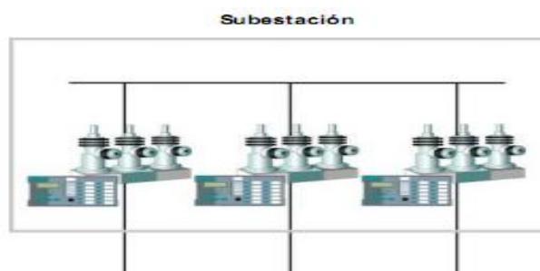
Figura 58: Ubicación de Reconectores en sub estación tomado de catálogo Siemens.
