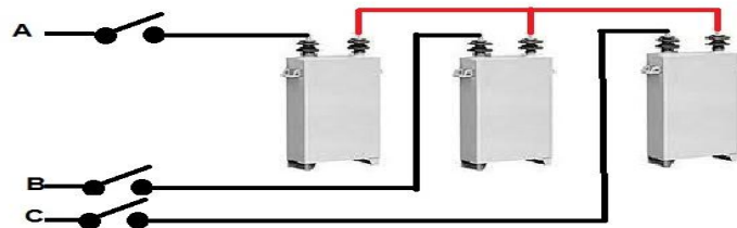
Figura 73: Banco de Capacitores en estrella con neutro flotante.
