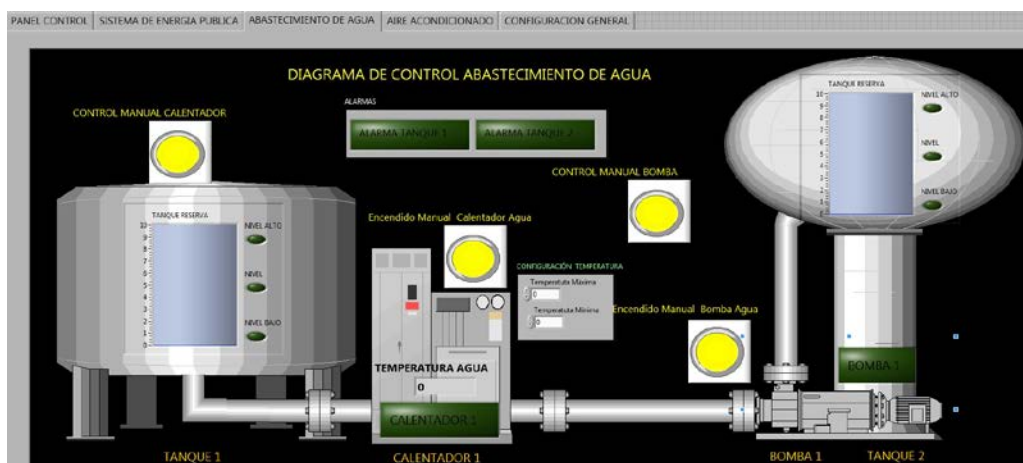
Figura 4.6 Panel de usuario de abastecimiento de agua y sistema de caldero
