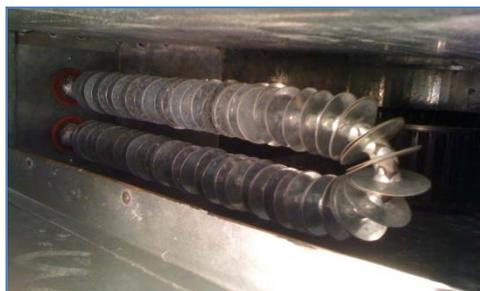
**Figura 3.17:** Resistencia de calefacción.
