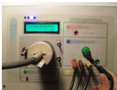
Figura 4.18. Conexión de las derivaciones del EKG al módulo.
