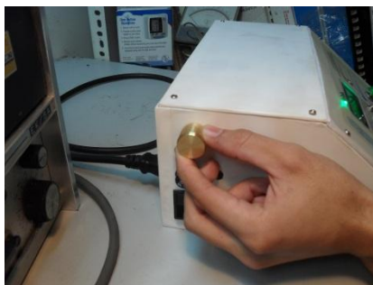
Figura 4.16. Potenciómetro de ajuste de contraste del display.
