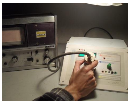
Figura 4.17. Conexión del EKG al módulo.
