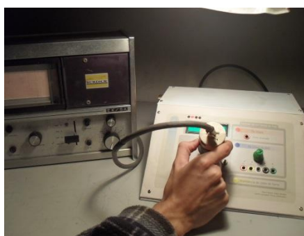
Figura 4.9. Conexión del EKG al módulo.
