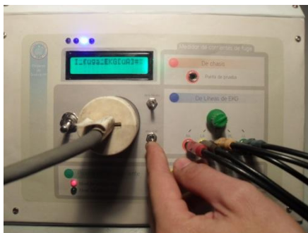
Figura4.14. Switch abrir tierra.
