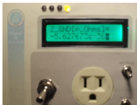
Figura 4.7. Valor impedancia de tierra.
