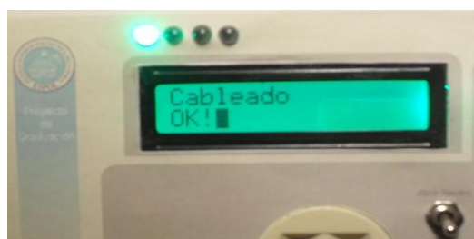
Figura 4.5. Módulo indicando cableado correcto del tomacorriente.
