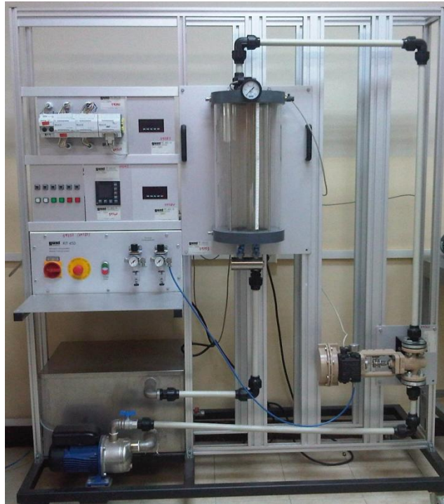
Figura 1.2: Planta de Regulación de Nivel
