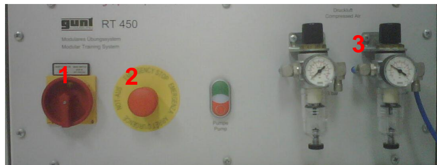
Figura 5.1: Interruptor principal, pulsador parada de emergencia y alimentación de aire comprimido.
