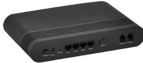
Figura 1.16-Terminal óptico de red. [27]
