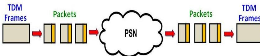
Figura 1. 25 Funcionamiento general de TDMoIP.
