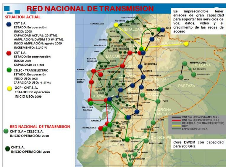
Figura 3. 9 Red Nacional de Transmisión Fibra Óptica – CNT. EP. [27]
