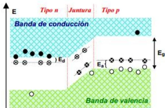
Figura 1.3: Doblamiento de las bandas de energía. [2]
