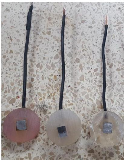
**Figura 3.4 Probetas experimentales desde izquierda a derecha, materiales: A36(prueba), A588 Probeta 1 y A572 Probeta 1**
