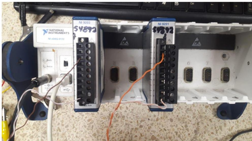
**Figura 2.2 Tarjeta de adquisición de datos NI cDAQ-9172**
