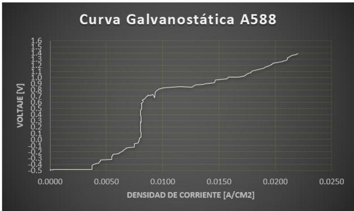
Figura 3.6 Curva Galvanostática de acero estructural A588 en medio salino.
