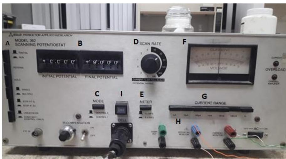
Figura 2.1 Potencio-Galvanostato Modelo 362
