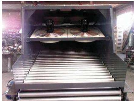
**Figura 1.3 Sistema de Secado por Túnel**
