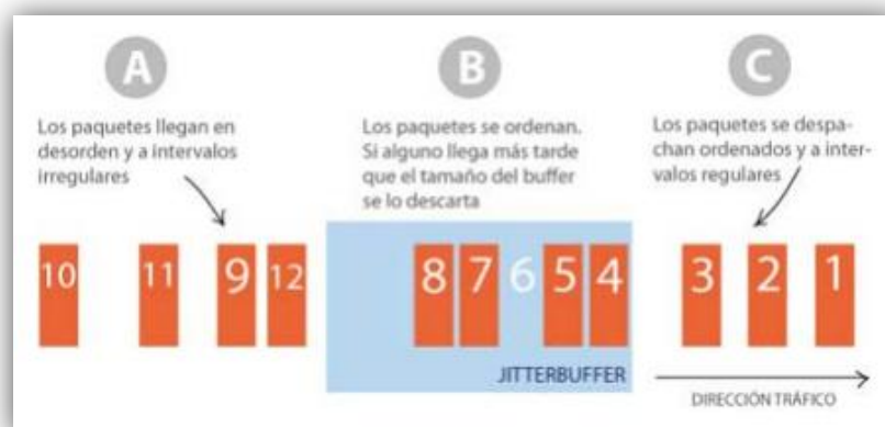
Figura 2.8. Esquema de funcionamiento de un jitter buffer
