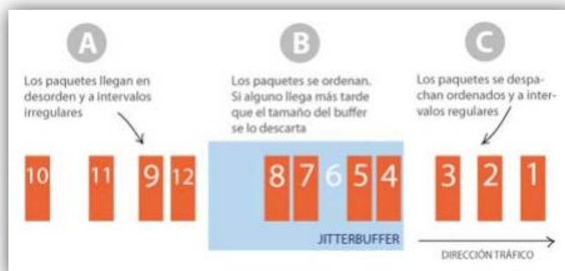
Figura 2.8. Esquema de funcionamiento de un jitter buffer
