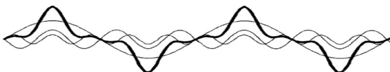
Figura 2.5. Distorsión de la fundamental causada por los armónicos.
