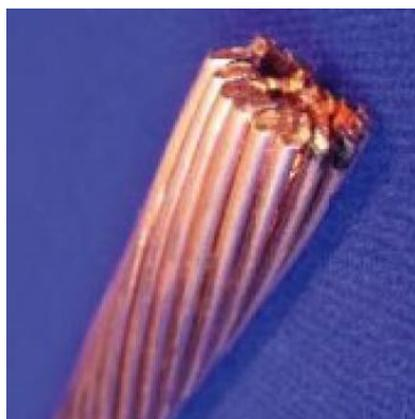
Fig.8.1 Conductor utilizado en el patio de 69 Kv
