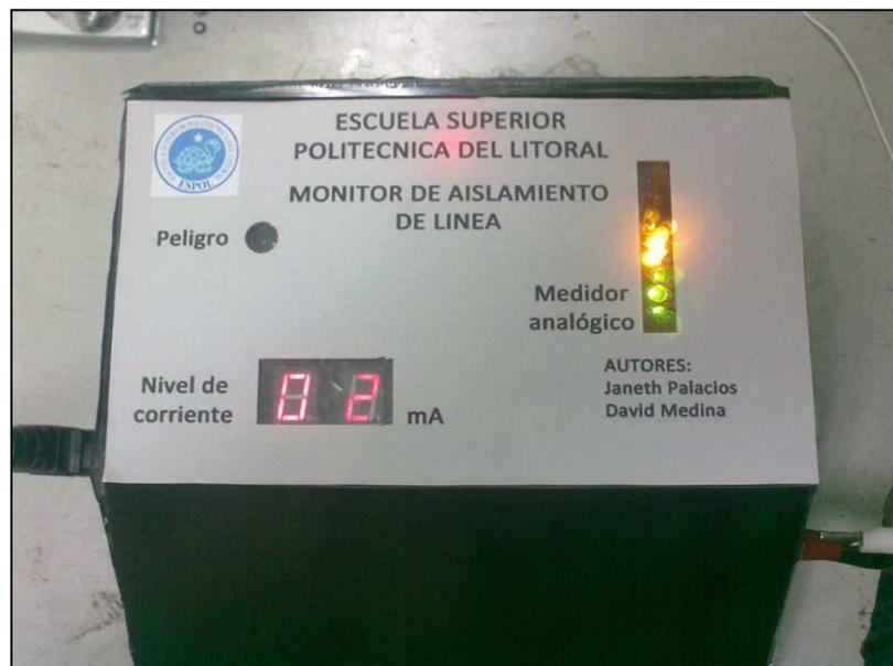
Figura D-2 Perspectiva Frontal del Equipo dentro del límite seguro de corriente.
