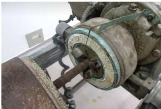
**Figura 1.3 Escala graduada para leer el ángulo de rotación.**
