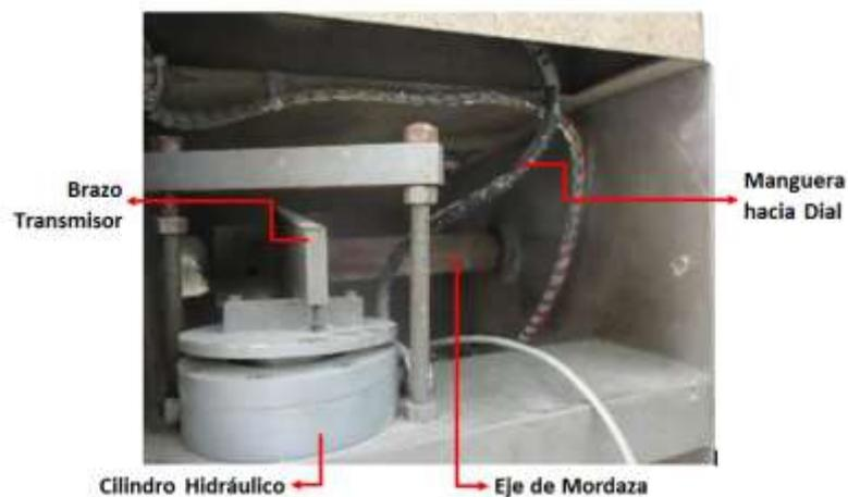
**Figura 1.2 Cilindro hidráulico que recibe el torque y transmite al dial.**
