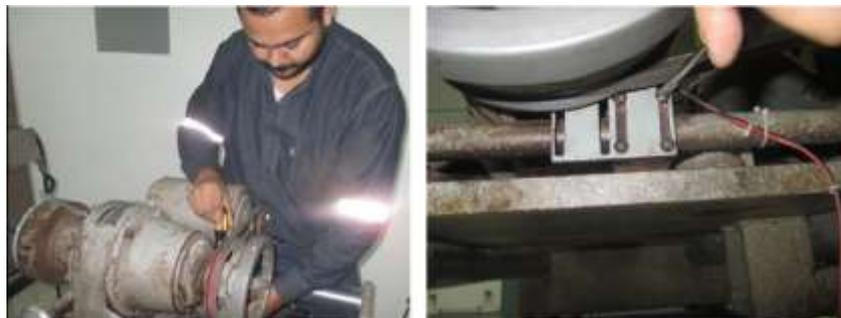
**Figura 2.5 Proceso de instalación de encoder óptico.**
