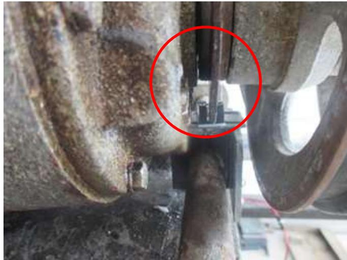
**Figura 2.6 Alineación entre encoder óptico y disco con agujeros.**
