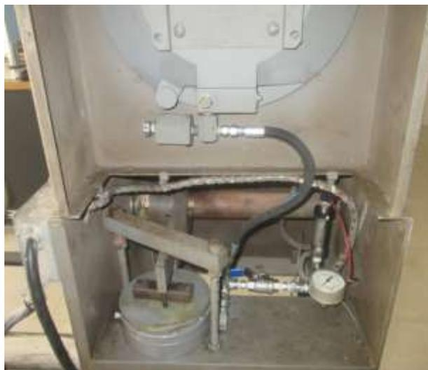
**Figura 2.2 Instalación final de transductor de presión.**
