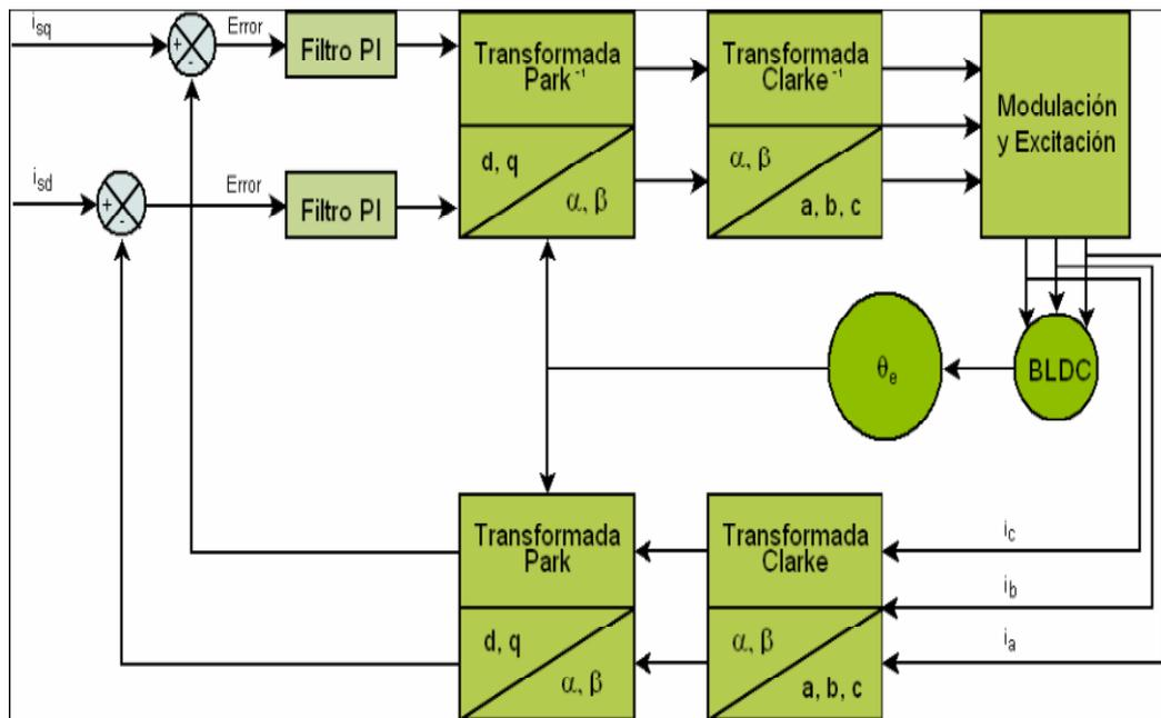
Fig. 2.22: ESQUEMA DE CONTROLADOR CON CONTROL VECTORIAL. [11]
