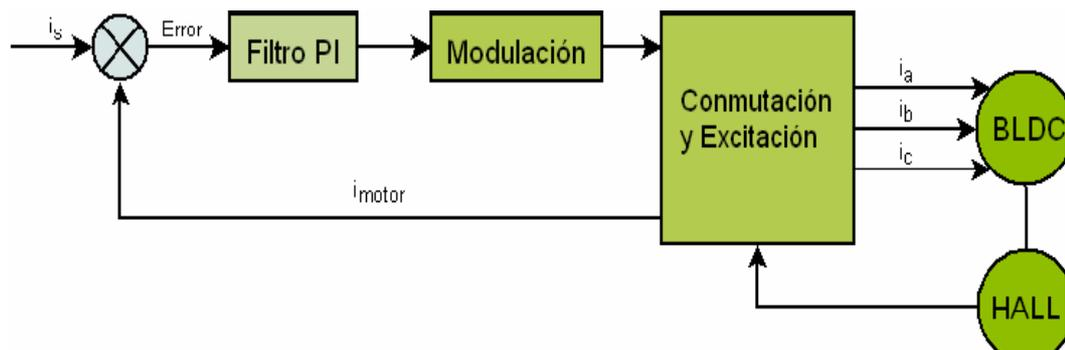
Fig. 2.18: ESQUEMA DE UN CONTROLADOR CON CONMUTACIÓN
