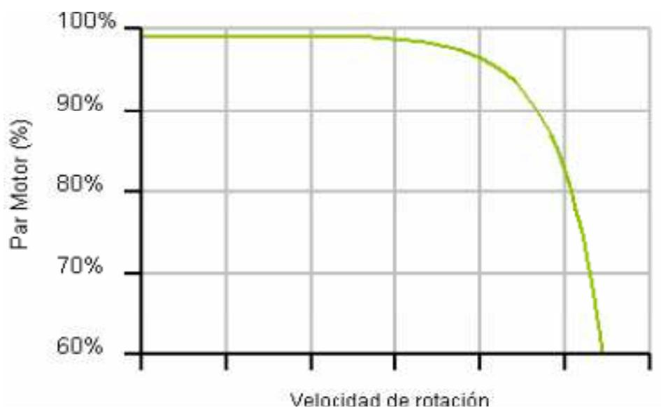
Fig. 2.21: PAR MOTOR EN FUNCIÓN DE LA VELOCIDAD DE ROTACIÓN. [11]
