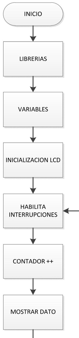
Fig. 3.6: Diagrama de flujo de butterfly usando LCD
