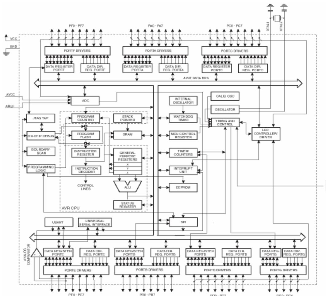
Fig. 2.5: Diagrama de bloques del microcontrolador ATmega169. [8]
