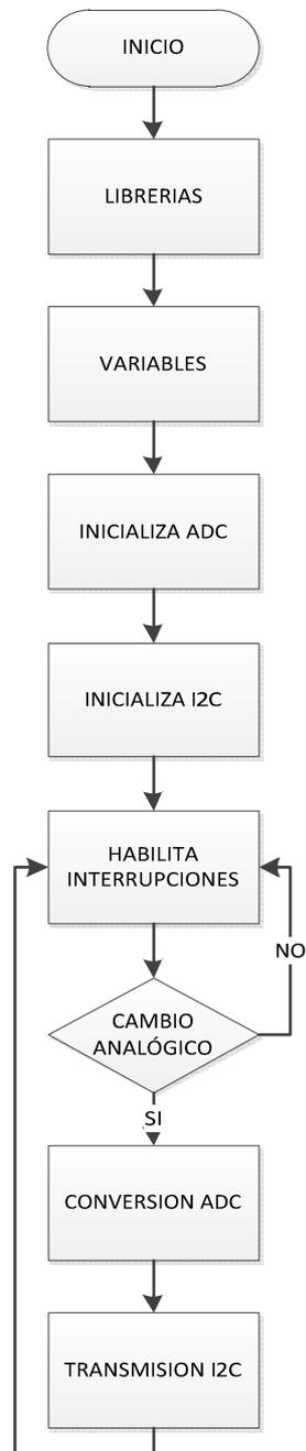
Fig. 3.8: Diagrama de flujo de comunicación entre LPCXpresso como Master.
