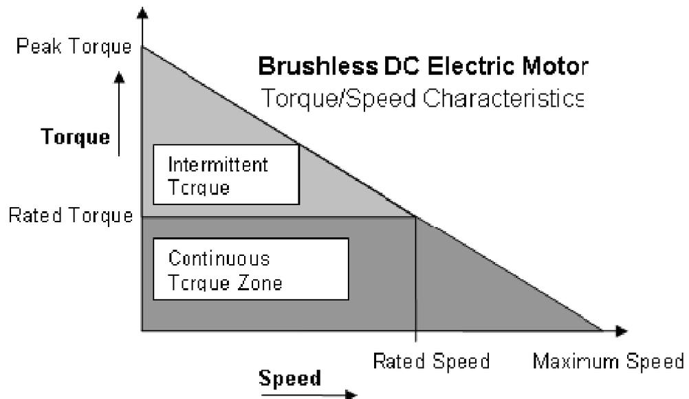
Fig. 2.23: Características Torque vs Velocidad. [13]
