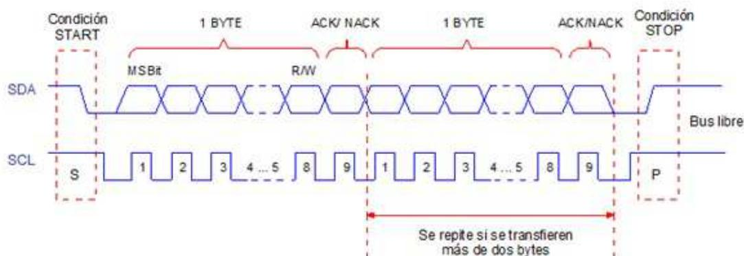
Fig. 2.14: Esquema de la Transmisión de datos
