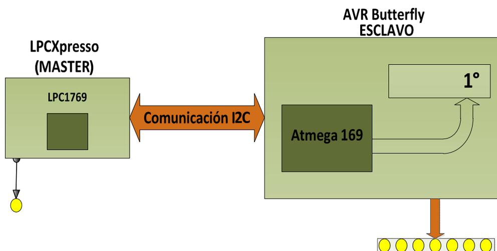
Fig. 3.7: Diagrama de bloques de comunicación entre LPCXpresso y Avr butterfly.
