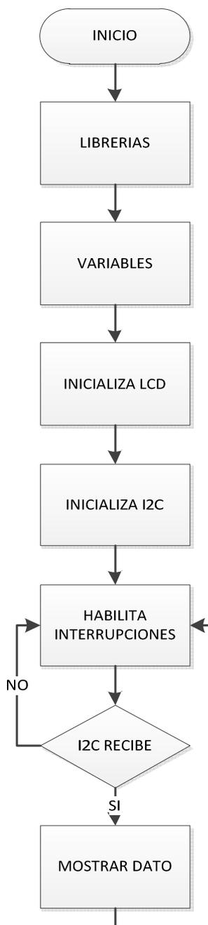
Fig. 3.9: Diagrama de flujo de comunicación Avr Butterfly como Esclavo.
