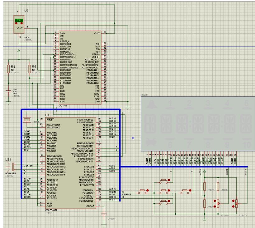
Fig. 4.8: Diagrama eléctrico entre AVR Butterfly y LPCXpresso
