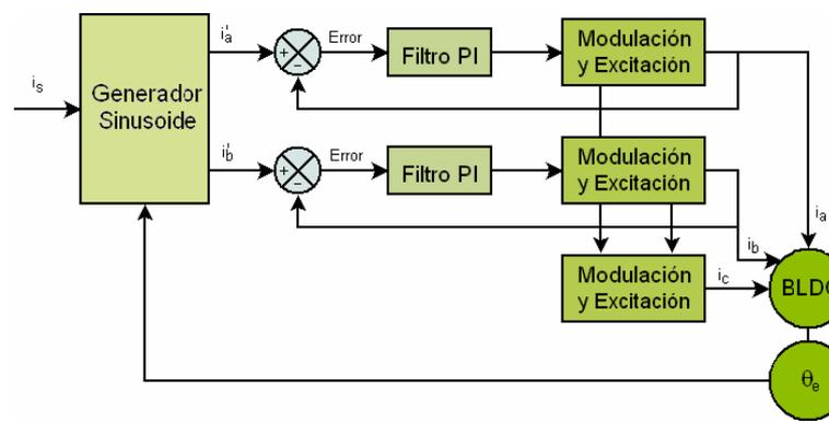
Fig. 2.20: ESQUEMA DE UN CONTROLADOR CON CONMUTACIÓN SINUSOIDAL. [11]
