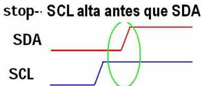
Fig.2.15: Condición STOP
