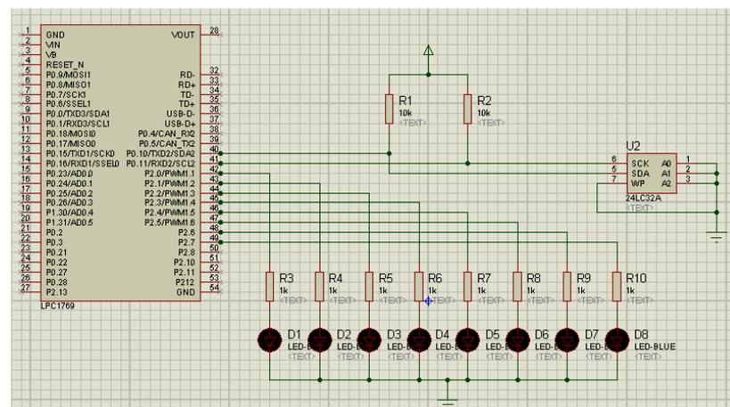
Fig. 4.2: Diagrama eléctrico de la LPC1769 y la EEPROM.
