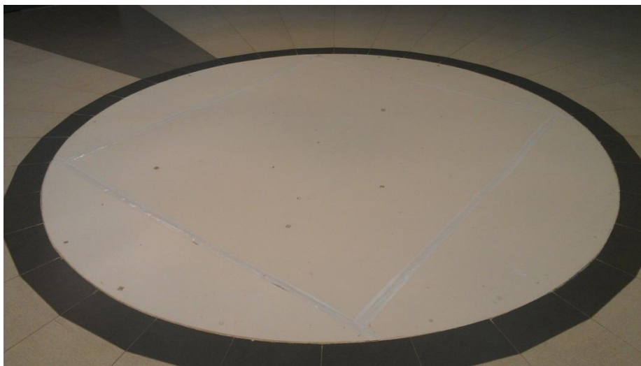
Figura 4.8 Panel de madera aglomerada
