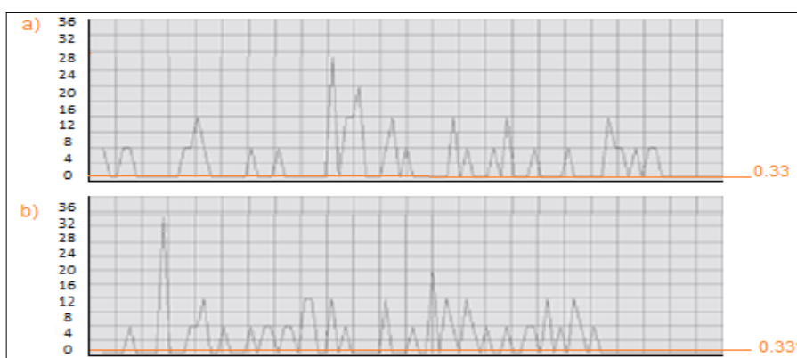
Figura 5.5: Uso del procesador cliente FTP a) Antes del ataque; b) Después del ataque
