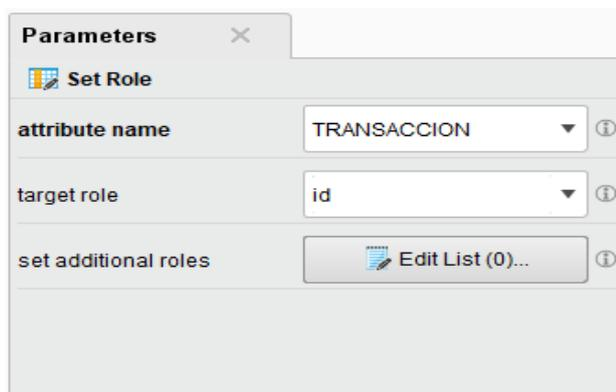
**Figura 5.12** : Configuración del operador Set Role
