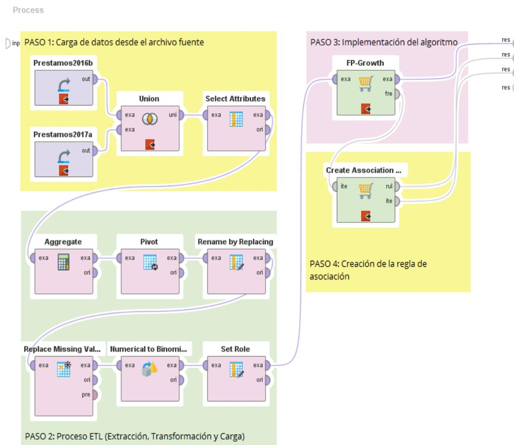
**Figura 5.10** : Proceso para la implementación del modelo
