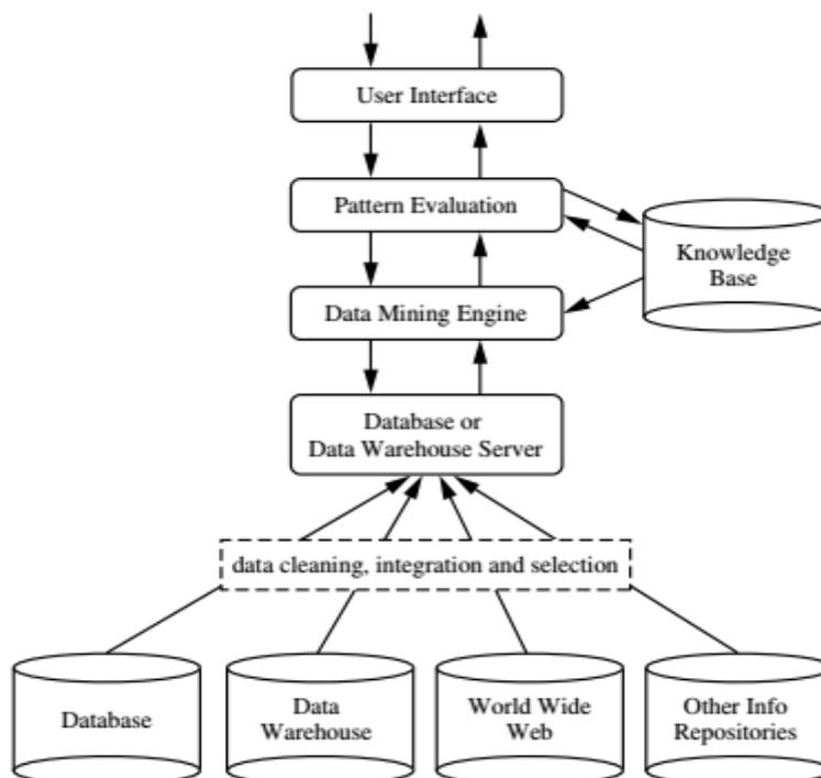
**Figura 2.12** : Arquitectura típica de un sistema de Minería de Datos.
