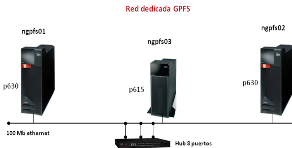
Figura 4.1 Detalle de la red interna o dedicada para GPFS
