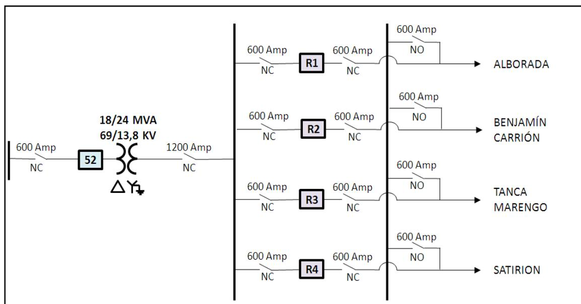
Figura 1.1 Diagrama unifilar de la subestación Alborada
