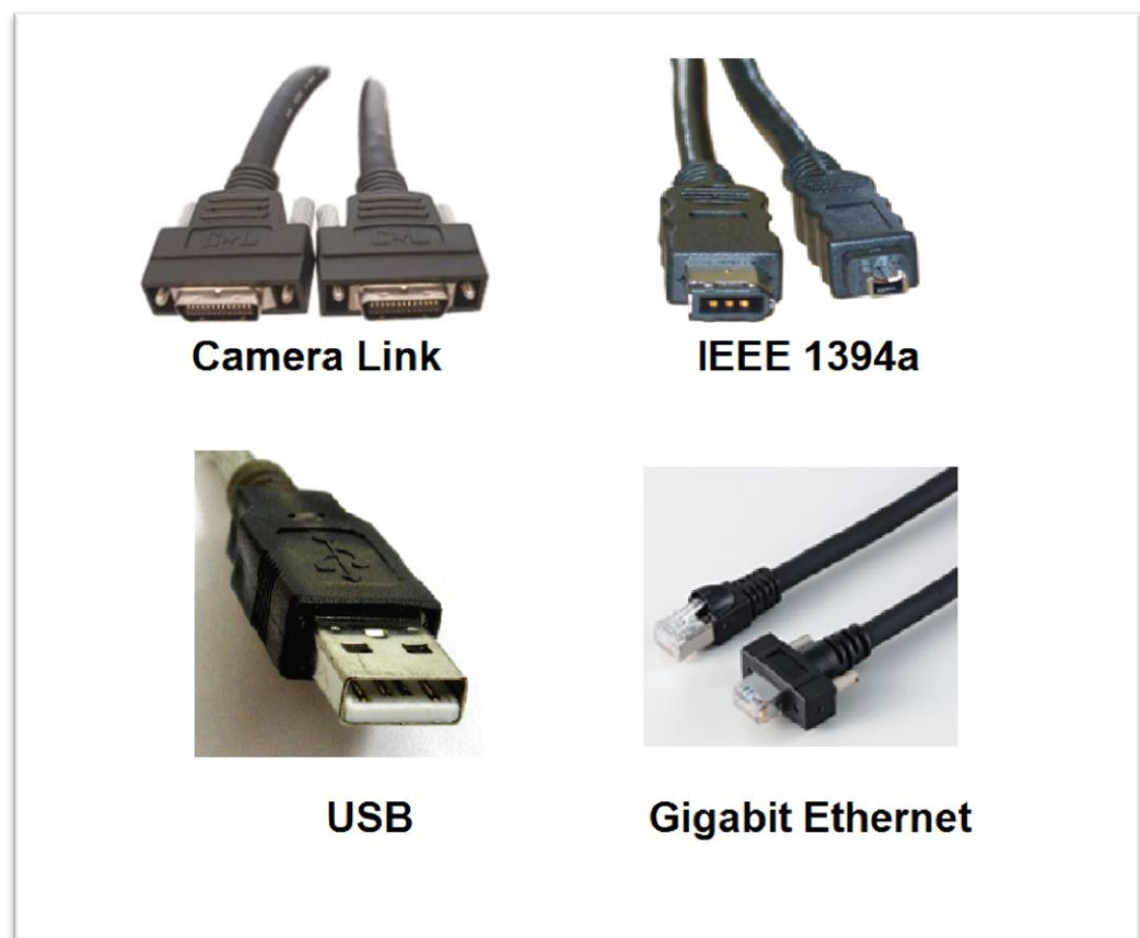
Figura 3.2 Tipos de conectores para transmisión de video
