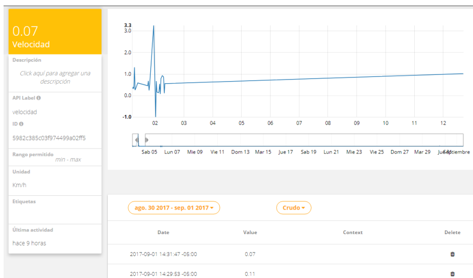
Figura 4.13: Recepción de datos en la variable velocidad en la nube de Ubidots.
