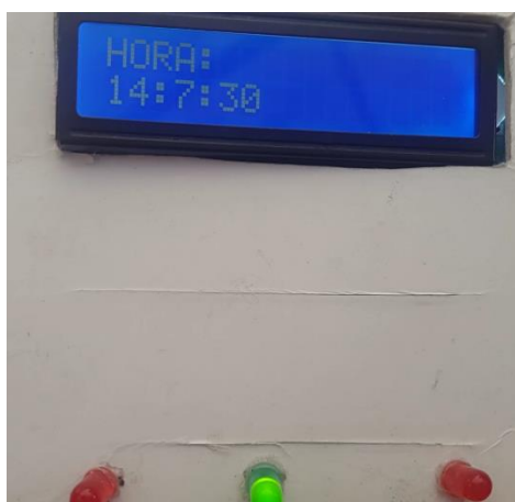
Figura 4.7: Adquisición de datos de hora a través del módulo GPS.
