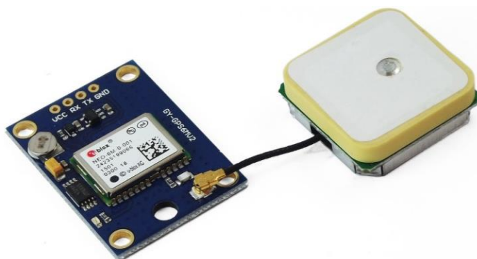
Figura 3.5: Módulo GPS GY-GPS6MV2. [10]
