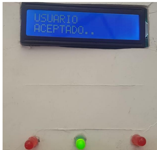
Figura 4.3: Usuario aceptado por el módulo RFID.
