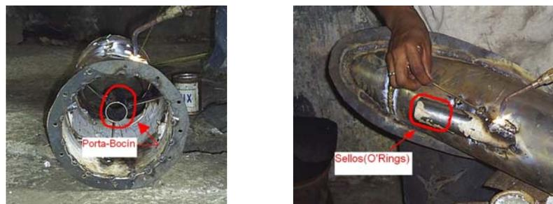
Figura 3.21.- Soportes del eje de la bomba.
