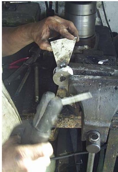
Figura 3.19.- Unión de aspa a la manzana de la bomba.
