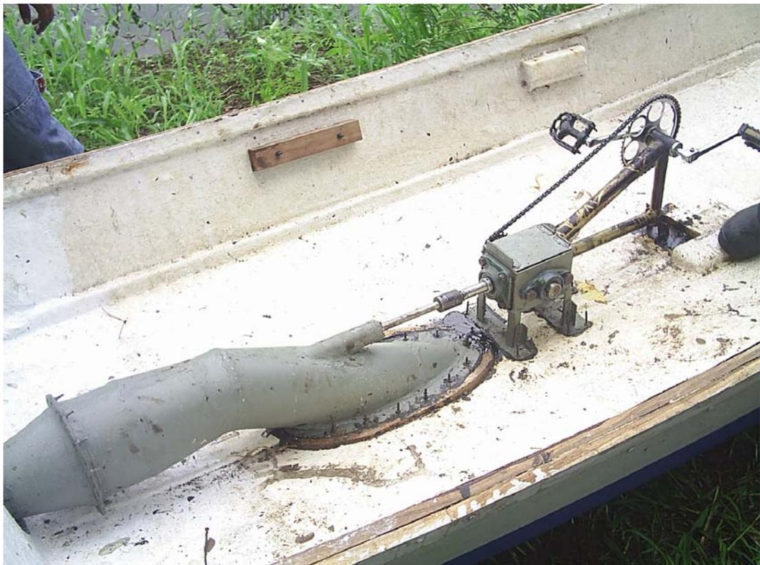
Figura 3.24.- Sistema de propulsión instalado.
