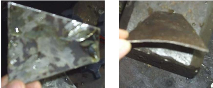
Figura 3.18.- Aspa del impeler.
