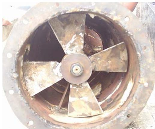
Figura 3.23.- Impeler de la bomba instalada en el sistema de ducto.
