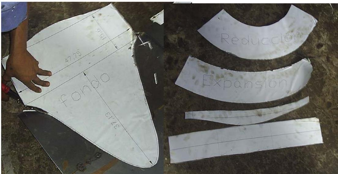
Figura 3.9.- Corte de las secciones del sistema de ducto.
