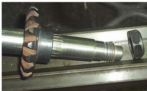
Figura 3.14.- Maquinado del eje donde va a trabajar el rache.
