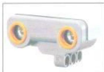
Figura 2.6 Sensor Ultrasonico NXT.
