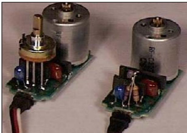
**Figura 2.13: Circuito de control del servomotor**
