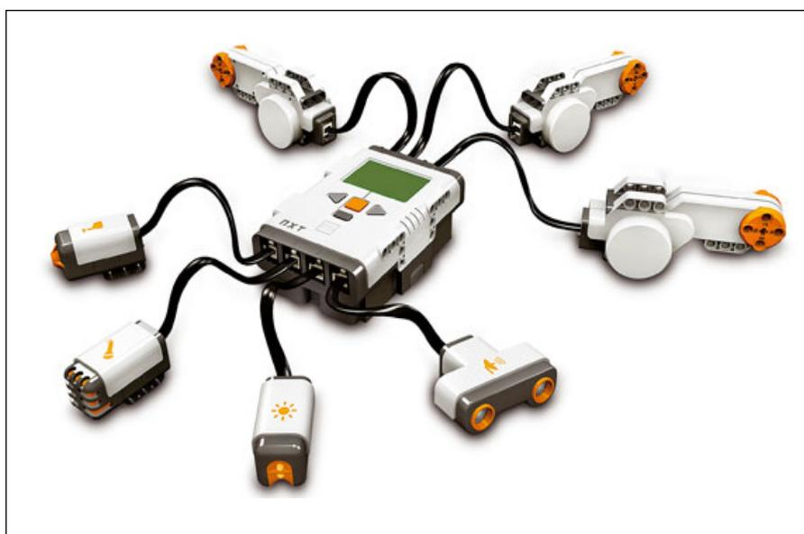
**Figura 2.1: Imagen del LEGO Brick y sus componentes**
