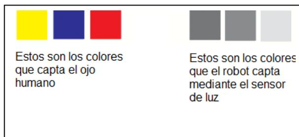
**Figura 2.4: Imagen del color captado en el sensor de luz**
