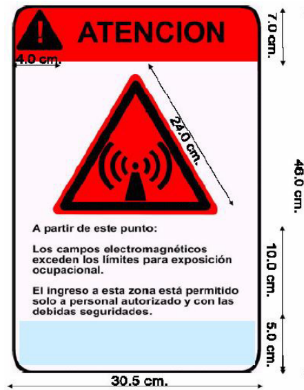
Figura. Señalización de advertencia Zona Ocupacional
