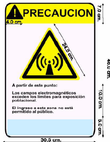
Figura. Señalización de advertencia Zona Ocupacional
