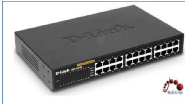
Figura 4-3 Conmutador D-LINK DES-1024D
