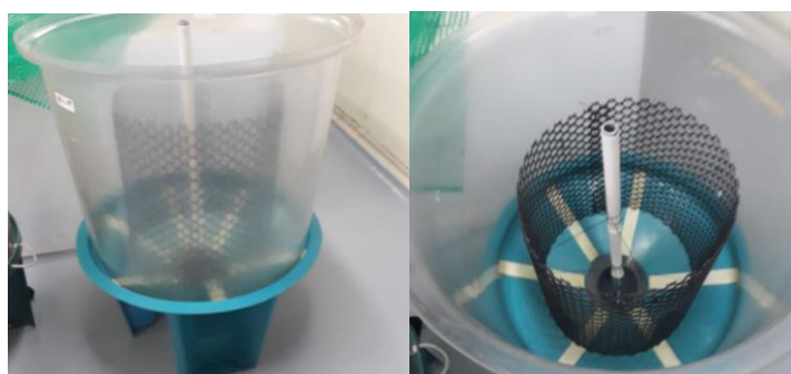
Figura 2. 8 Diseño de la cámara respirométrica
