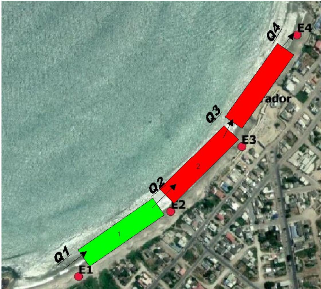
**Ilustración 55.- Representación de procesos erosivos/acrecivos para Qs promedio mediante el modelo SBAS**
