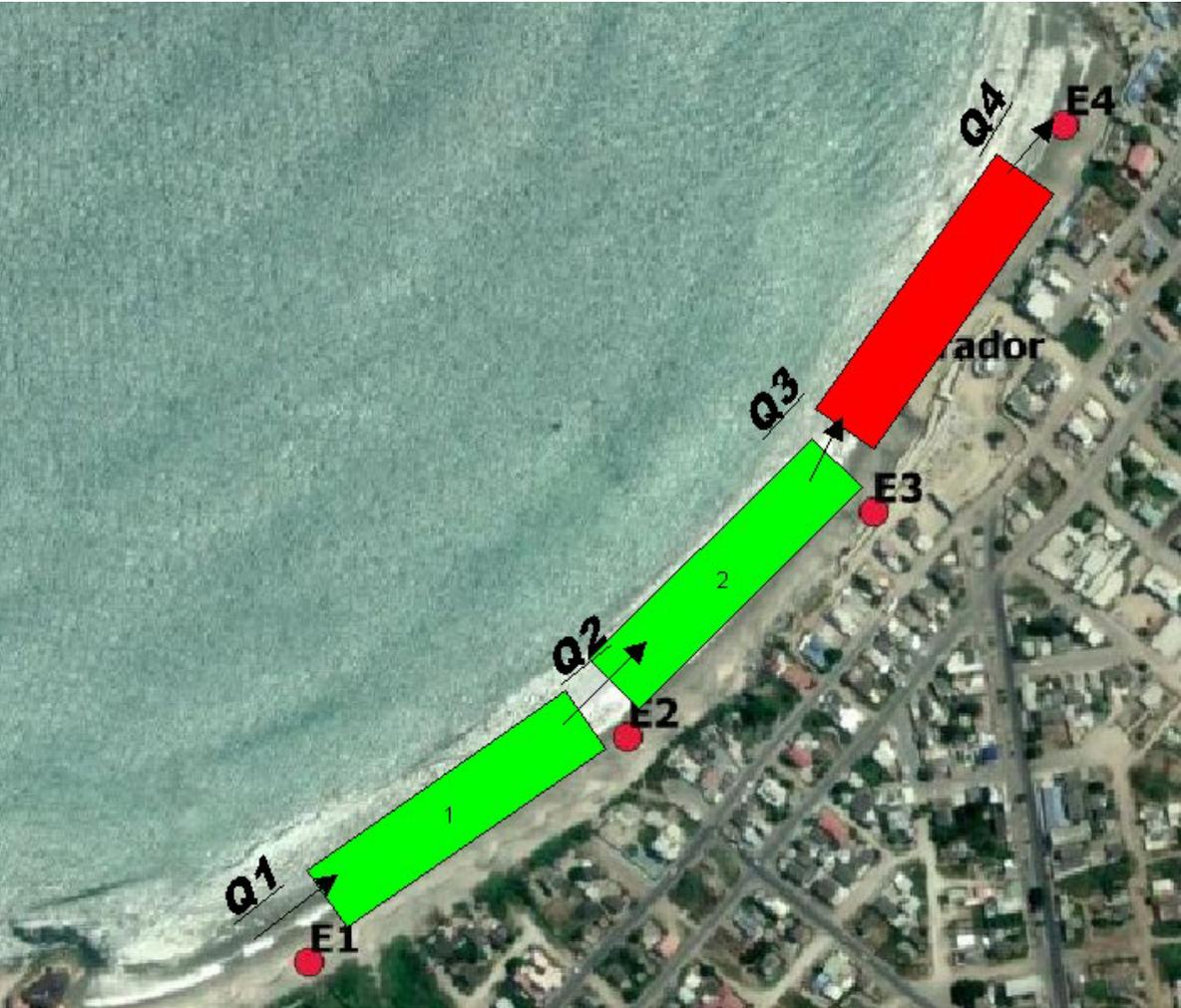
**Ilustración 54.- Representación de procesos erosivos/acrecivos para cuadratura con el modelo SBAS**
