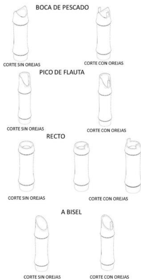
Figura 2-4 Ejemplos de cortes para uniones en Gak
