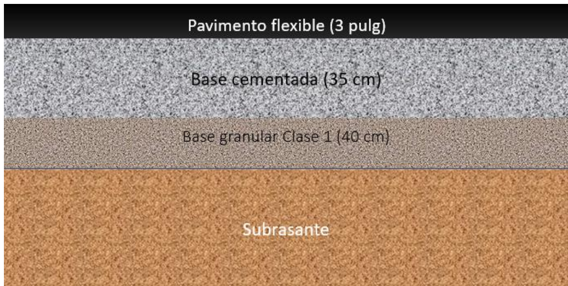
Figura 5.3 Diseño definitivo Base Cementada con Pavimento Flexible
