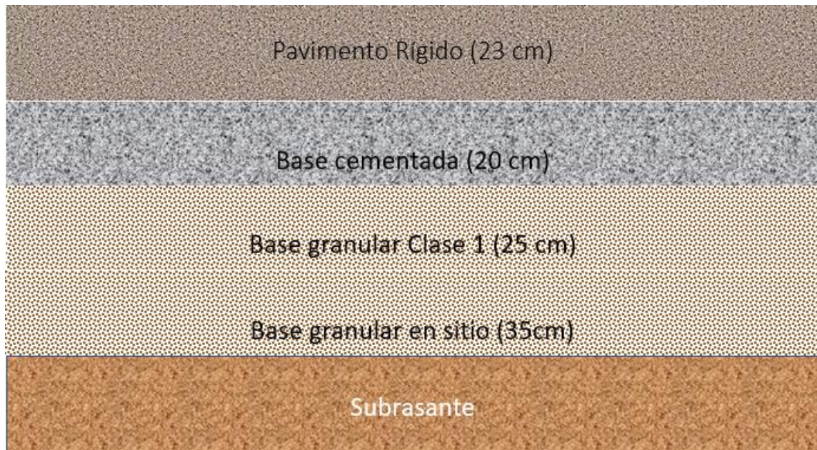
Figura 5.11 Diseño definitivo Metodología Losa de Geometría Optimizada
