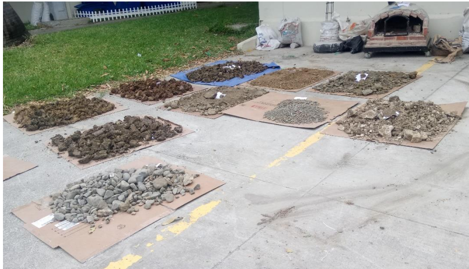
Figura 2.7 Secado de muestras al sol por 24 horas
