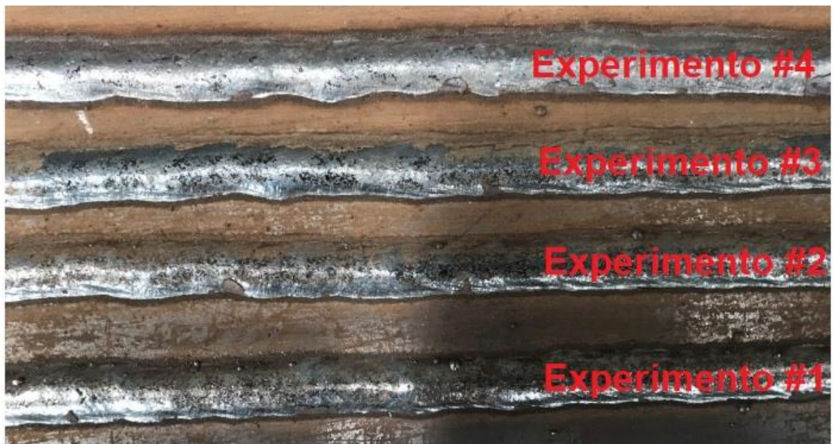
Figura 3. 18. Cordones de soldadura realizado por soldador
