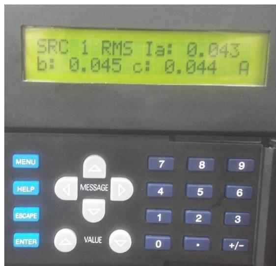
Figura 3.12 Corrientes de fase leídas por el relé digital
