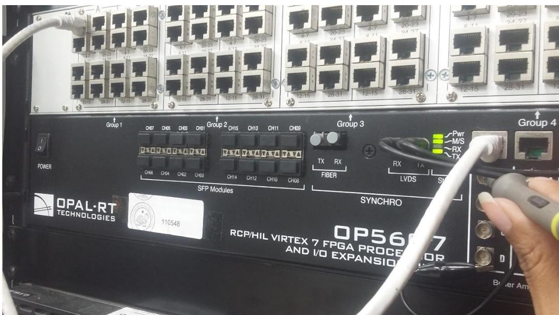
Figura 3.9 Obtención de señal de voltaje en módulo OP5607
