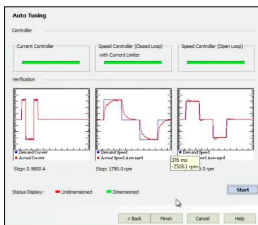
Figura 2.19: Ventana de Sintonización Automática con el proceso ya finalizado.
