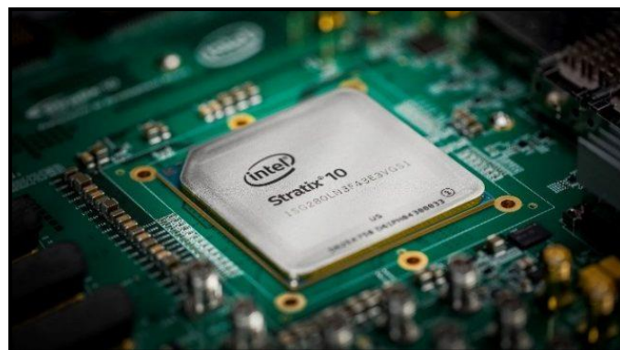
Figura 2.20: FPGA Stratix 10 creada por INTEL Altera.
