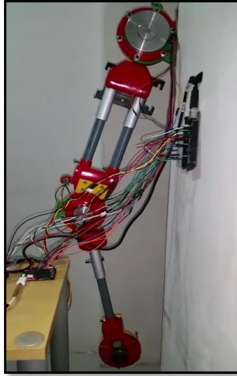
Figura 3.16: Estructura de la pierna izquierda del Exoesqueleto
