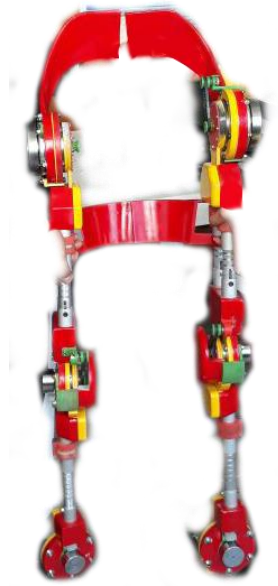
Figura 3. 14: Diseño del prototipo impreso en PLC
