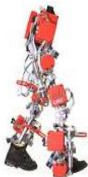
Figura 1.3: ATLAS 2020 exoesqueleto pediátrico
