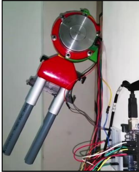
Figura 3.15: Parte de la estructura de la pierna izquierda
