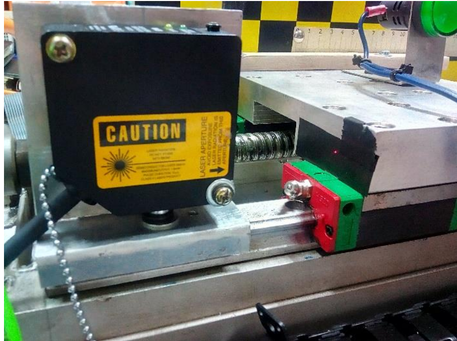
Figura 2.14 Sensor láser instalado
