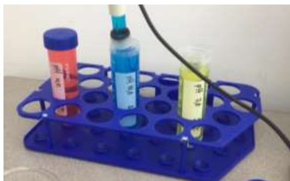
Figura 2.15 Calibración del sensor de pH
