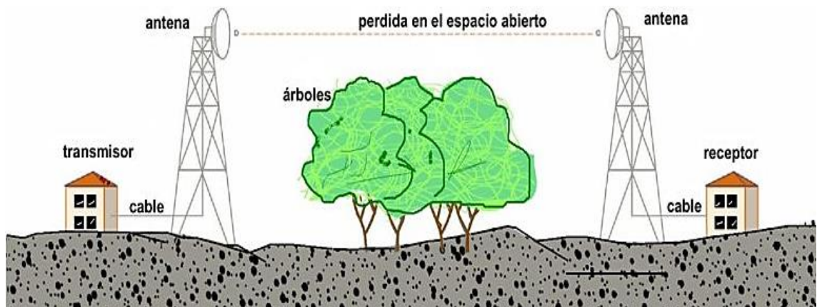
Figura 2.1 Esquema de un Radioenlace [11]
