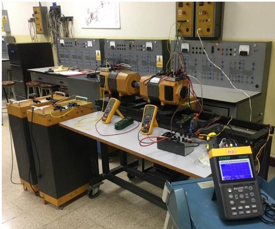
**Figura 4.1. Fotografía de la prueba de cortocircuito repentino, realizada en el Laboratorio de Máquinas Eléctricas.**
